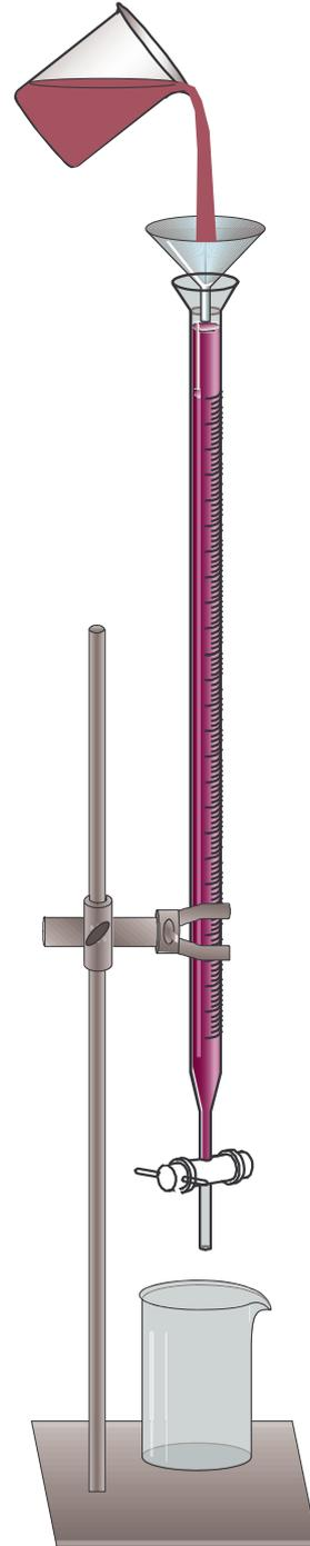
Ajuster le zéro et chasser la bulle d'air sous le robinet.
