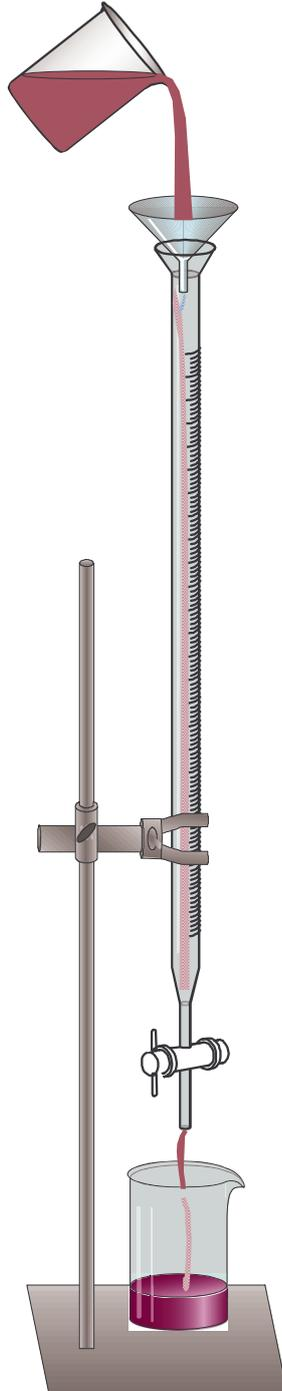
Fermer le robinet et remplir la burette avec la solution à utiliser.
